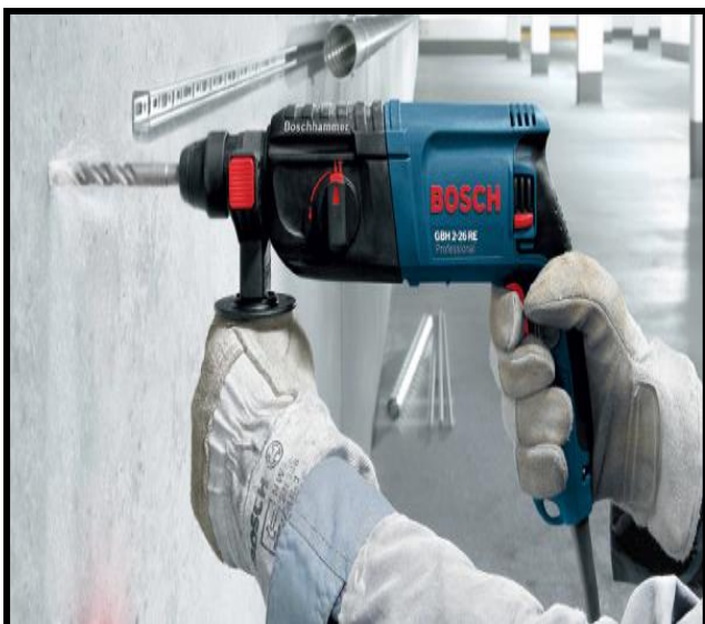
Sử dụng máy khoan phải đeo găng tay tránh giật điện
