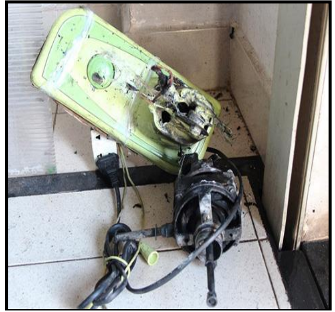
Quạt treo tường bị cháy đen do có chất lượng kém
