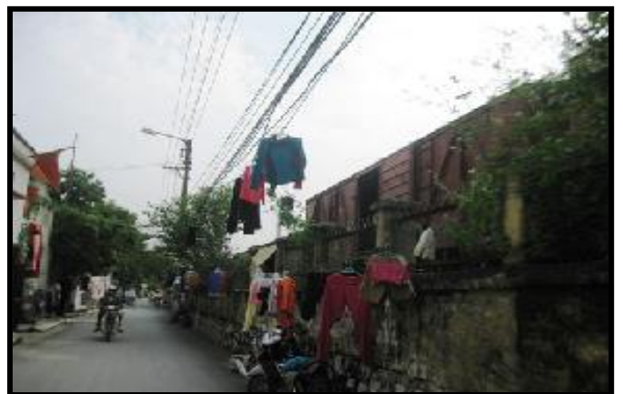
KHÔNG : Phơi quần áo trên đường dây điện để tránh va chạm gây phóng điện, dẫn tới tai nạn
